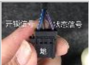
3.8 接开锁信号线：用我们的蓝色线按图示开锁信号线；接状态信号线：用我们的棕色线（低边）接图示状态信号线，白色线（高边）不需要接，包好固定即可
