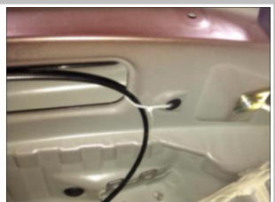
1.10 用扎带把圆圈位置的拉线固定好, 防止拉线与盖板、钣金摩擦;( 图片仅供参考)
