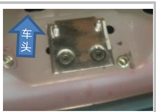
1.5 用两颗内六角沉头螺钉 M6 20 安装垫板组, 根据箭头提示方向装上我司配的垫板, 平行拧紧;( 图片仅供参考)
