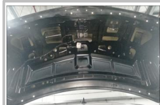
3.4 如图尾箱毛毡板已取下，毛毡板妥善保管
