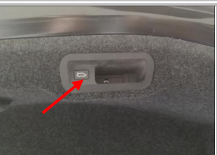
4.6 安装开关按钮：在原车此处装上开关按钮，线束插头对插好
