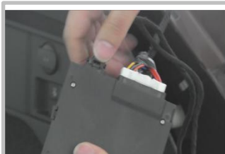
4.1 连接 ECU，将所有各部位线束插头连接好，最后把主线束插头对应安装到 ECU 上，先黑后白的顺序接上
