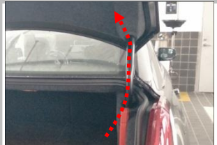
3.5 布线 把 2 扎布线束（接开关、接门锁信号、）从尾箱右侧沿着摇臂延伸到上门锁（虚线）
