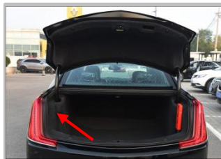
3.1 拆卸左侧盖板，
