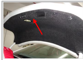
3.7 接门锁信号线：在拆开尾门上盖板，在上门锁位置找到如图接头；
