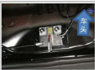
1.6 用大垫圈、弹垫圈、六角法兰面螺母 M6 配合门锁主体安装楔块把锁扣组固定在门锁垫板上, 注意螺母平行拧紧;
