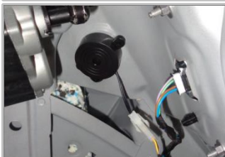
4.4 安装蜂鸣器：与 ECU 接口对接，并把蜂鸣器装在右侧装饰板内空旷处；
