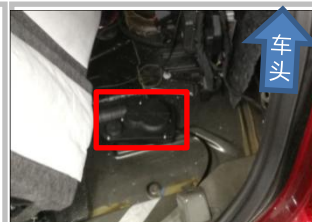
1.9 把包装好的驱动盒安装在右侧如图位置固定好
