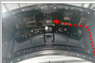
3.6 布线：把 2 扎布线束（接开关、接门锁信号）延伸到尾箱上门锁扣处，延伸线用胶布或扎带固定好；（虚线）
