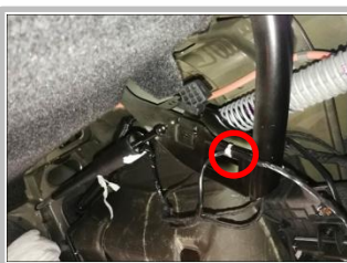
2.6 如图示意线束用扎带固定好，并预留足够活动空间，防止开关门时线束被刮蹭、拉断现象
